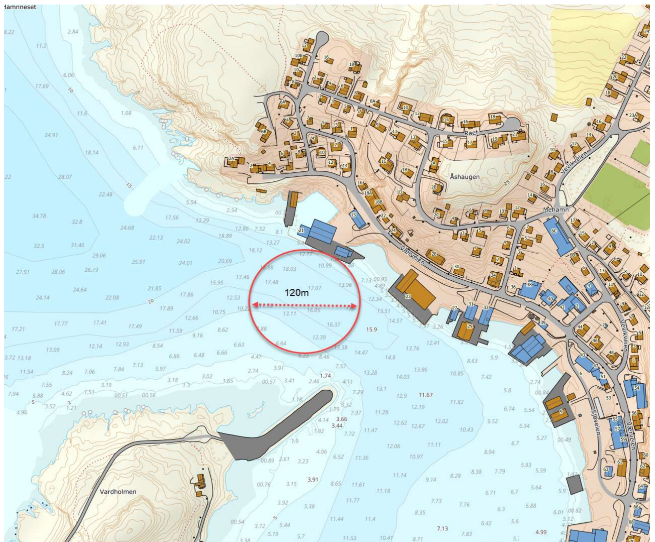
Figur 4-2: Figuren viser Havnebassenget utenfor kaianlegget med dybder(LAT)
